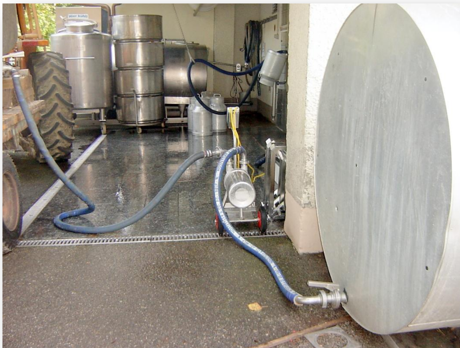
Die Pumpe befördert die Schotte von dem einen in den anderen Schottentank
